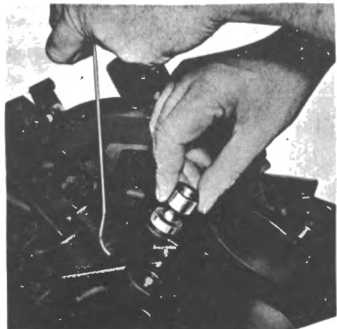
Fig. A:25 Removing the tappets
